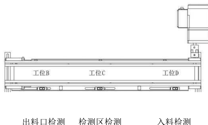
图 3-1 传送带机构安装示意图
